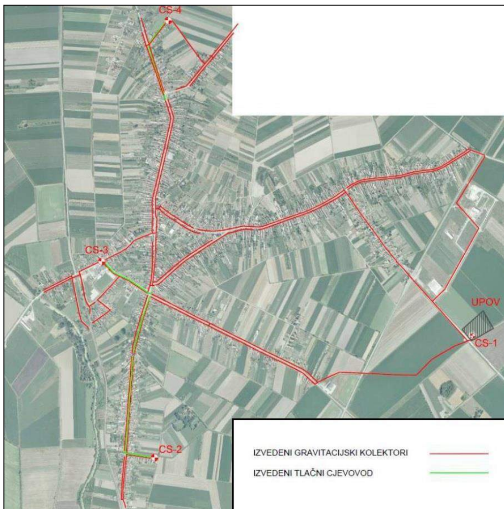
Slika 1.1.1-2. Postojeći sustav odvodnje Gradište
